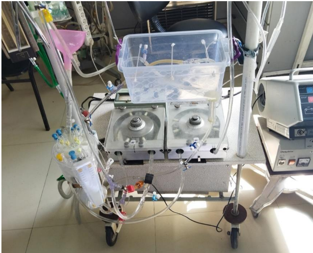
სურათი 6. სტანდარტული აგებულების ღვიძლის საპრეზერვაციო მანქანა აწყობილი გორგოლაჭოვანი ტუმბოს გამოყენებით და სტანდარტული აქსესუარებით. (მანქანა გამოვიყენეთ II ჯგუფის ექსპერიმენტებში).
