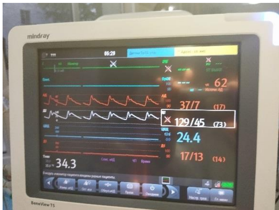
სურათი 5. შემუშავებული პულსატორის მიერ რეალიზებული წნევის მრუდი აორტაში არსებულ მრუდთან მაქსიმალურად მიახლოებული, ტიპური დიკროტული ნაჭდევით, რომელიც აორტული სარქველის დახურვაზე მიუთითებს.
