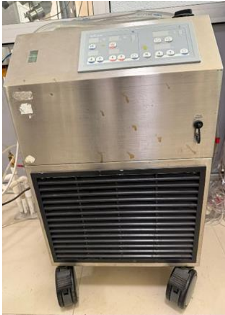
სურათი 9. თბომომცვლელი STOCKERT Heat Exchanger, რომელიც უზრუნველყოფს სისხლის ტემპერატურის მართვას ოქსიგენატორში და პარალელურად სპლანქნური სითხის ტემპერატურის მართვას ორგანოთა კონტეინერში.
